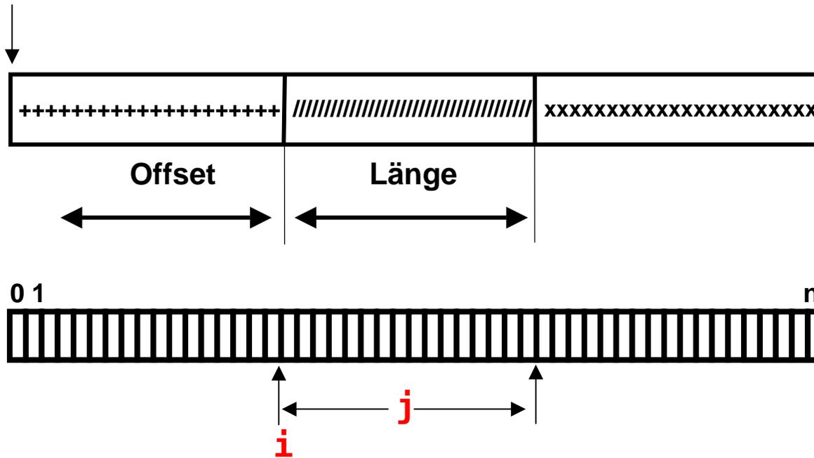
Eine Unix, Linux oder Windows File besteht aus einer linearen Folge von Bytes mit den Adressen 0...n. Bei einem Lesezugriff
