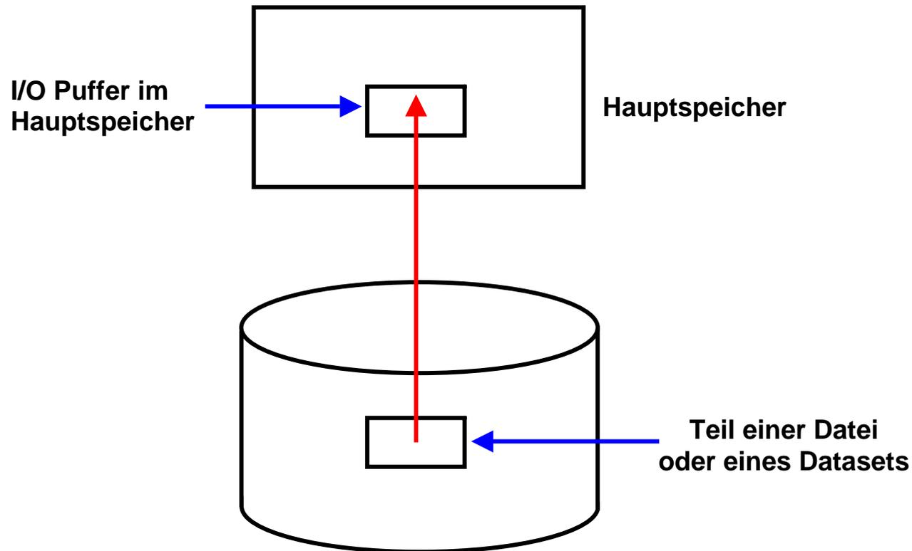
Bei einem READ Zugriff auf den Plattenspeicher wird eine Gruppe von Bytes aus einer Datei von der Festplatte in einen als I/O Buffer bezeichneten Bereich innerhalb des Hauptspeichers gelesen.
