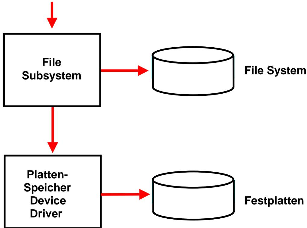
Anwendungsprogramme greifen selten oder nie direkt auf einen Plattenspeicher zu. Stattdessen greifen sie auf eine abstrakte Struktur zu, die je nach Funktionsumfang als File System oder als Datenbank bezeichnet wird.
