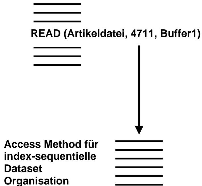
Das Anwendungsprogramm gibt nur den Namen der Datei (Artikeldatei), den Indexwert eines Records (4711) sowie den Namen eines Speicherbereichs im Hauptspeicher (Buffer1) an, in den ein Record mit der Artikelnr. = 4711 gespeichert werden soll. Die Access Method des Kernels macht den Rest.
