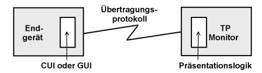
Abb. 9.1.2 Für die Verbindung mit CICS benötigt der Klient eine spezielle Komponente
