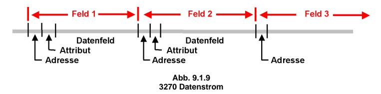
Der 3270 Bildschirm besteht aus 24  $\alpha$ /n Zeilen mit je 80 fixed Font-Width Zeichenpositionen pro Zeile. Das Adressenfeld kennzeichnet eine der 24 x 80 = 1920 Zeichenpositionen auf dem Bildschirm (Zeile und Spalte).
