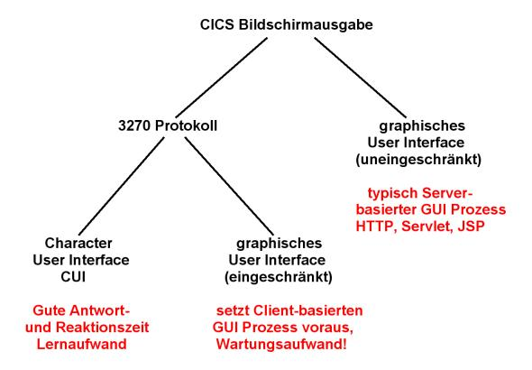
Abb. 9.1.4 existieren zwei unterschiedliche Möglichkeiten für eine grafische Benutzerschnittstelle
