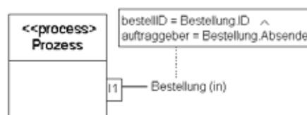
Abbildung 4.31: Mögliche graphische Notation von Korrelationsprädikaten.
